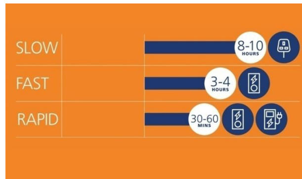
Figura 2. Viteze de încărcare a mașinilor electrice
